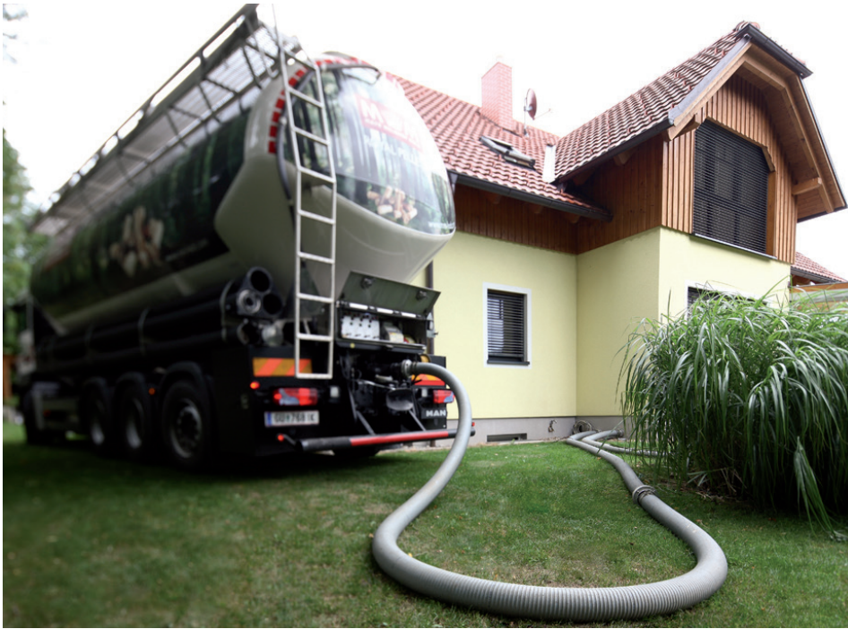
Das Befüllen eines Pelletslagers erfolgt durch Einblasen vom Tankwagen und dauert für 5 Tonnen Pellets ohne Umrüstzeiten etwa 15 bis 30 Minuten.
