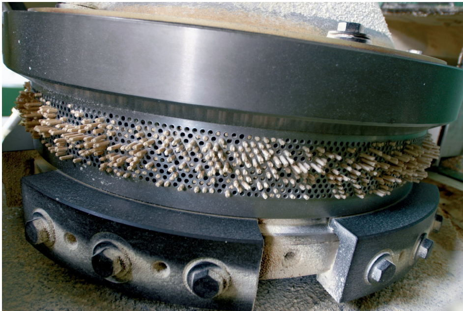
Abb. 10: So entstehen Pellets – Hobel- und Sägespäne werden von Walzen durch einen Stahling mit Bohrlöchern – die Pelletspresse – gedrückt. Foto: proPellets Austria
