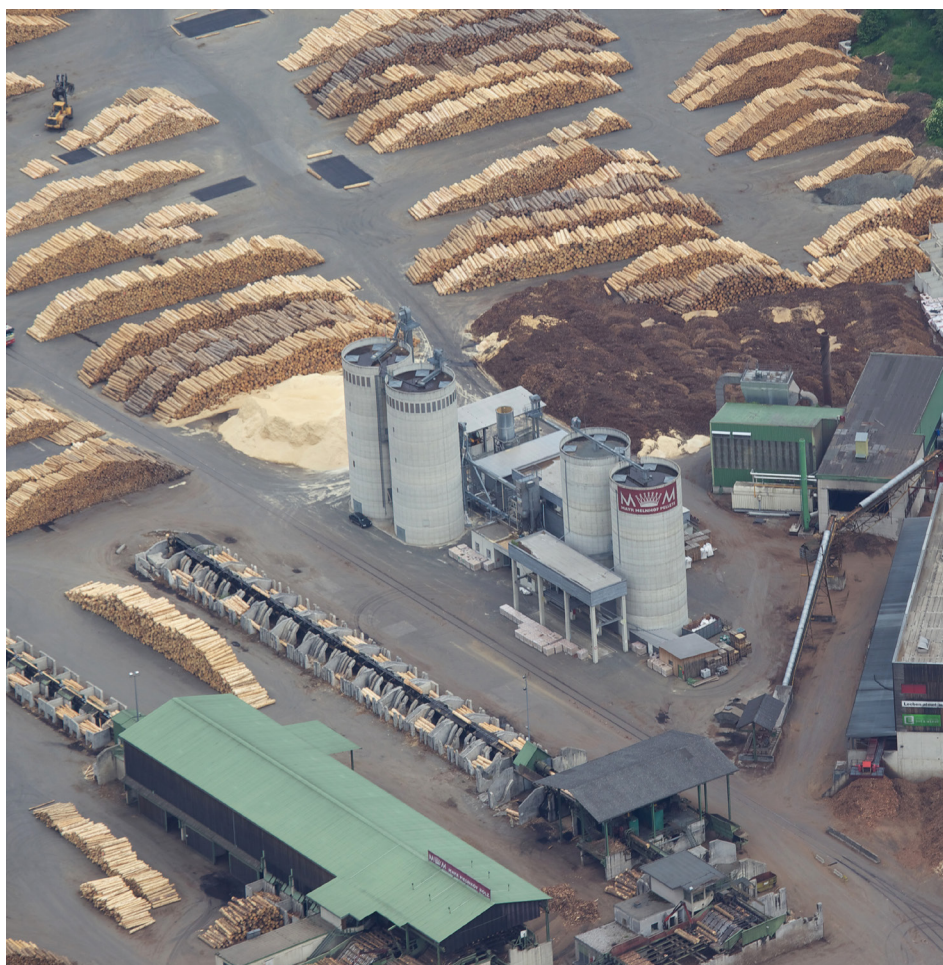
Abb. 9: Pellets werden in Österreich zu einem Großteil direkt an den Standorten der Holzindustrie aus den bei der Verarbeitung anfallenden Sägenebenprodukten hergestellt.
